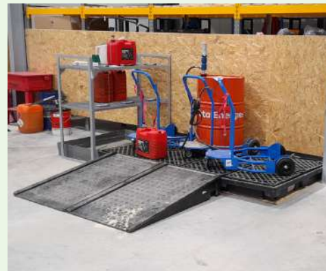
les fûts restent difficiles à déplacer avec cette rétention
