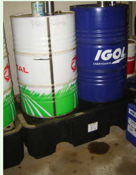
cette rétention nécessite l'utilisation d'une pince lève-fût
