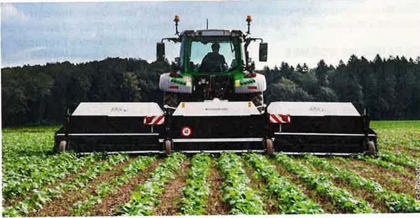
Le modèle Ara d'Ecorobotix pulvérise uniquement sur les adventices ciblées (chardons et rumex). La précision se conjugue au présent. L'avenir sera sans doute à la détection, voire à la prévention.
