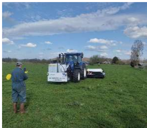
Le pulvérisateur Ara Ecorobotix, mesure 6 m de large et comporte 156 buses à spectre étroit (4 cm).
