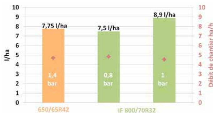
**Peu d'écart de consommation** entre le 650/65R42 et l'IF à 0.8 bar. La pression de 1 bar pour l'IF est inadaptée
