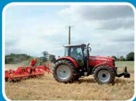
Au labour le fait de diminuer la pression des pneus de 0,6 bar a permis d'économiser 2 litres par hectare sur une monte de pneus standards.
