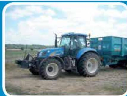
Les tracteurs tiraient une benne vide puis remplie de grain. La remorque chargée de blé, le poids total des ensembles variait de 27,4 à 28,6 tonnes.
