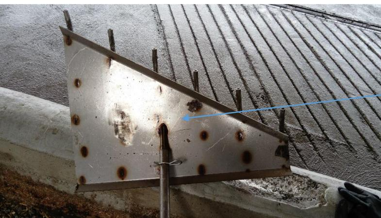
Plaque à rainurer composé de 6 doigts de 13mm de diamètre, angle de 60°
